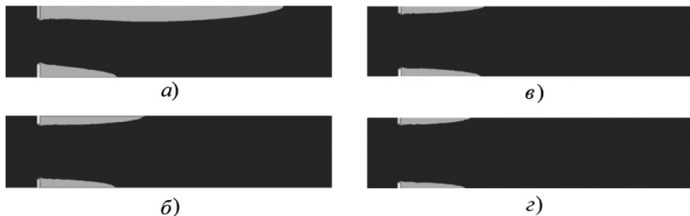
Рис. 2. Области отрицательной проекции скорости на ось x , модель k-\omega , сетки большого объема: а) q = 0,36 ; б) q = 0,21 ; в) q = 0,20 ; г) q = 0,18 .
