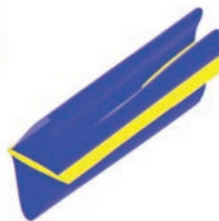
Рис. 9. Контуры сверхзвуковых зон при обтекании сегмента крыла удлинения 4 для угла крутки \delta\phi = 0,72^\circ и средних углов атаки -0,845^\circ (слева), -0,84^\circ (в центре) и -0,835^\circ (справа).
