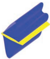
Рис. 6. Контуры сверхзвуковых зон при обтекании сегмента крыла удлинения 2 для угла крутки \delta\phi = 0,72^\circ и средних углов атаки -0,843^\circ (слева) и -0,84^\circ (справа).
