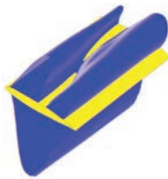
Рис. 8. Контуры сверхзвуковых зон при обтекании сегмента крыла удлинения 2 для угла крутки \delta\phi = 3,6^\circ и средних углов атаки -0,855^\circ (слева), -0,845^\circ (в центре) и -0,84^\circ (справа).
