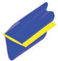
Рис. 7. Контуры сверхзвуковых зон при обтекании сегмента крыла удлинения 2 для угла крутки \delta\phi = 1,8^\circ и средних углов атаки -0,84^\circ (слева) и -0,83^\circ (справа).
