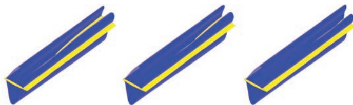
Рис. 10. Контуры сверхзвуковых зон при обтекании сегмента крыла удлинения 6 для угла крутки \delta\phi = 0,72^\circ и средних углов атаки -0,845^\circ (слева), -0,84^\circ (в центре) и -0,835^\circ (справа).
