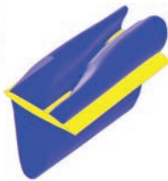
Рис. 8. Контуры сверхзвуковых зон при обтекании сегмента крыла удлинения 2 для угла крутки \delta\phi = 3,6^\circ и средних углов атаки -0,855^\circ (слева), -0,845^\circ (в центре) и -0,84^\circ (справа).
